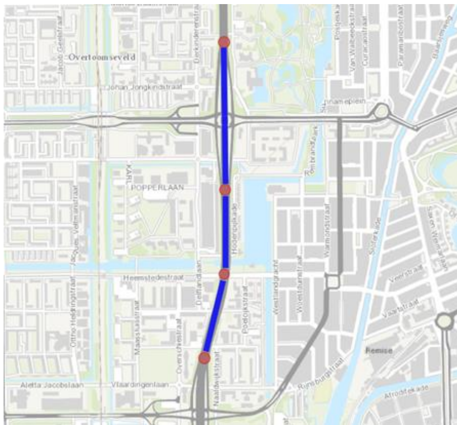
Figuur 40 De blauwe lijn is de weg of wegvak; dit is 1 line string. De weg is bij het tekenen opgedeeld in afzonderlijke segmenten, welke in de figuur begrensd worden door de rode bollen. SRM2 ziet elk wegsegment apart.
