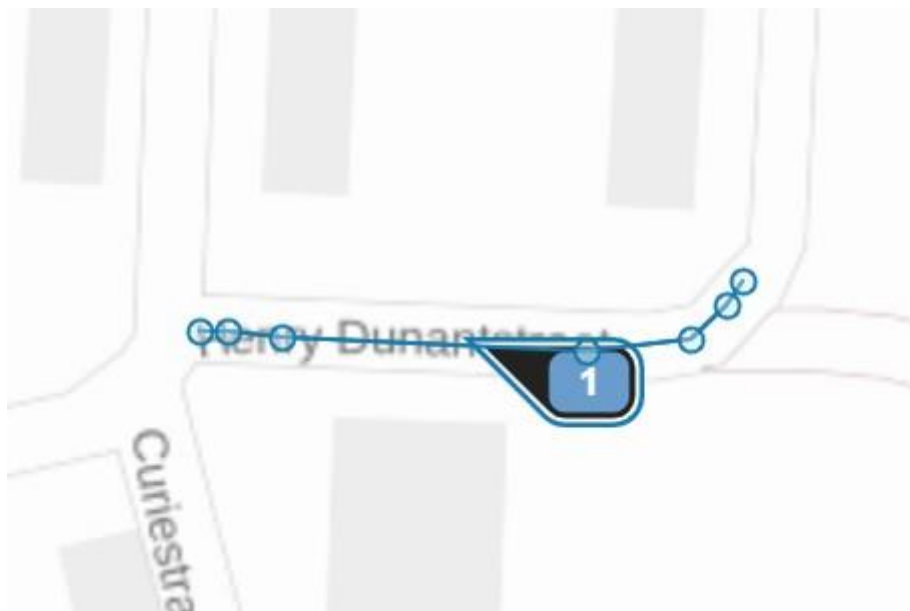
Figuur 20. Het wegvak als geheel (de lijnbron of linestring) is 60 meter lang en bestaat uit 6 wegsegmenten. SRM2 knipt ieder van de zes wegsegmenten op in gelijke delen van maximaal 2 meter lang. In het midden van die gelijke delen worden de puntbronnen neergelegd.
